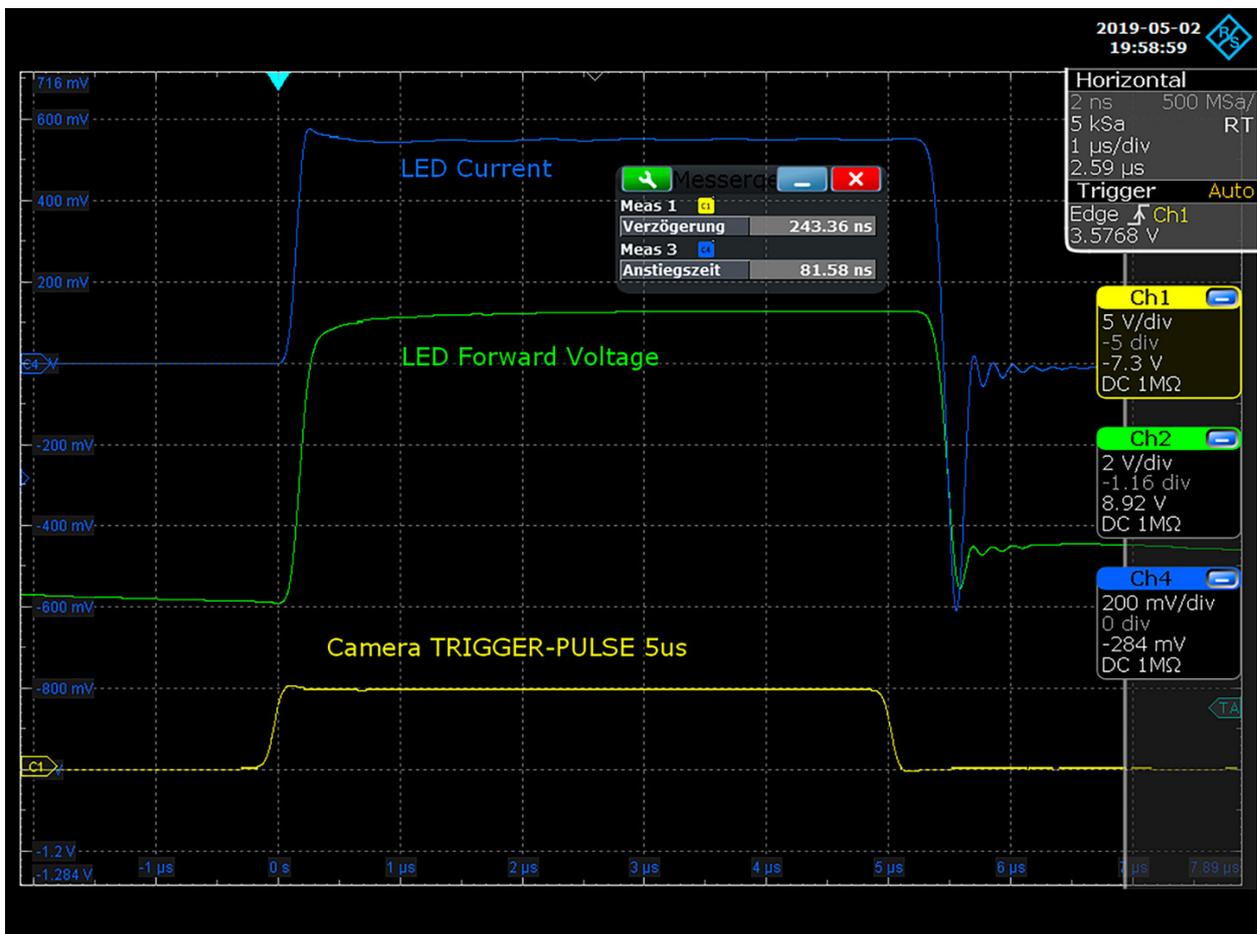
*Zeitverhalten von Kamera, Controller und LED-Beleuchtung bei einem 5µs langen Triggerimpuls. Jeder Lichtpuls erhält exakt die gleiche Energiemenge (Helligkeit). Die blaue Kurve entspricht der Leuchtdauer der angeschlossenen LED-Beleuchtung.*
