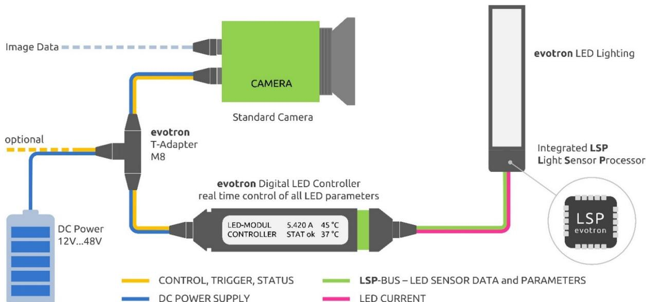
*Datenkommunikation zwischen Beleuchtung, Controller, Kamera und Bildverarbeitung.*
