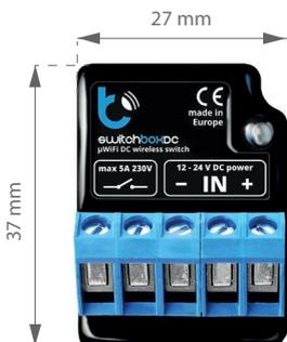
Die niedrige Versorgungsspannung erlaubt, dass das Steuermodul auch an Ecken **sicher verwendet werden kann** - z.B. neben der Duschkabine, dem Garten oder Pool.
