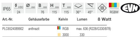
Aluminiumgehäuse • Schutzglas klar • Kunststoff-Erdspieß: L 170 mm • 1,50 m Anschlussleitung (H05RN-F 5 x 0,75 mm²) mit freien Aderenden •
